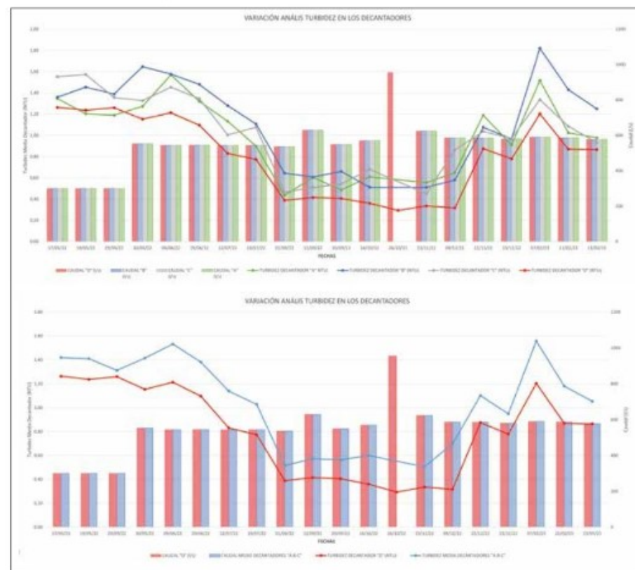
FIGURA 10. Comparación de la turbidez a igual caudal (decantador D con lamelas WssDynamics) y comparación de la turbidez media de los decantadores A, B y C con el decantador D a igual caudal.
